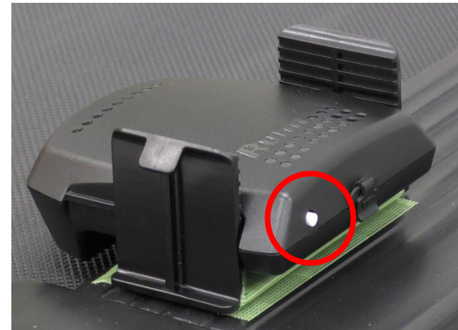
③ RUNNの白ボタンを2回タップし、電源ON
