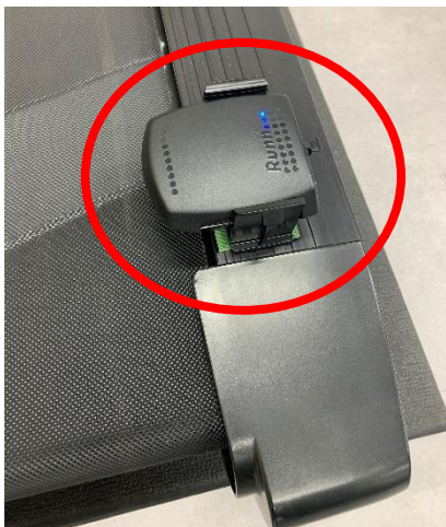
① ランニングデッキの平な部分に設置
