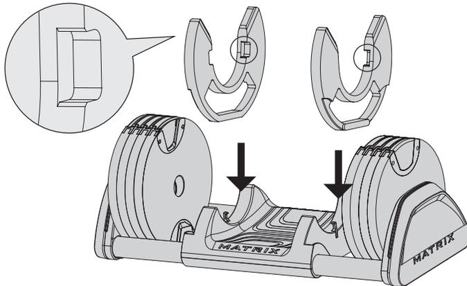
ハーフプレート(F)をクレードルのインナーサポート(G)のスロットに挿入し、ハーフプレートの溝(L)が互いに向き合うようにします。
