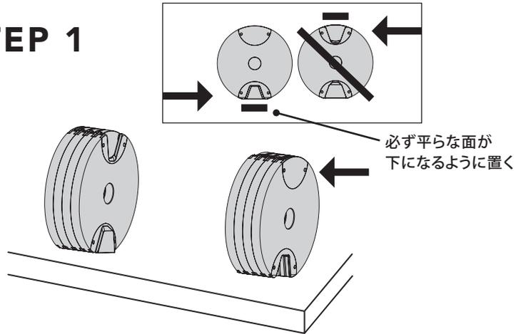
梱包を解き、平らな面にウェイトプレートを連結した対称的な2つのスタック(A)準備してください。各スタックにフラットコネクタ(C)を外側に向けたエンドプレート(B)があることを確認してください。スタックの平らな側を下向きにしてください。
